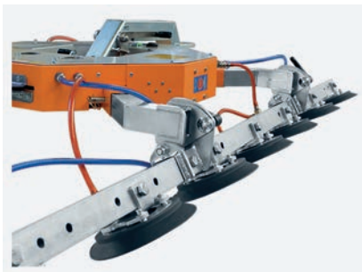
Met de traploos instelbare aanzuigadapters kunnen convexe en concave gebogen schijven met stralen \geq 1,0 m worden aangezogen
